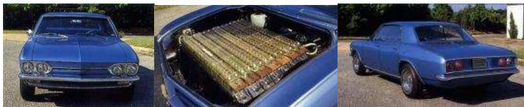
FIGURE 2.9 – Photos d'une Electrovaïr, avec ses batteries dans le coffre
