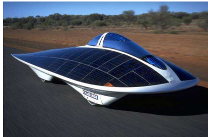
FIGURE 2.4 – Exemple de prototype de véhicule solaire
