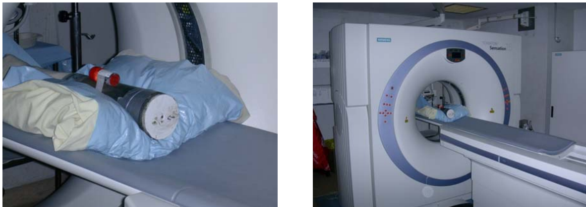
Figure 18 : Carotte en place sur le support du scanner
