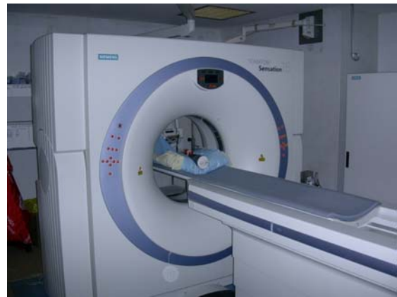
Figure 11 : Carotte en place sur le support du scanner
