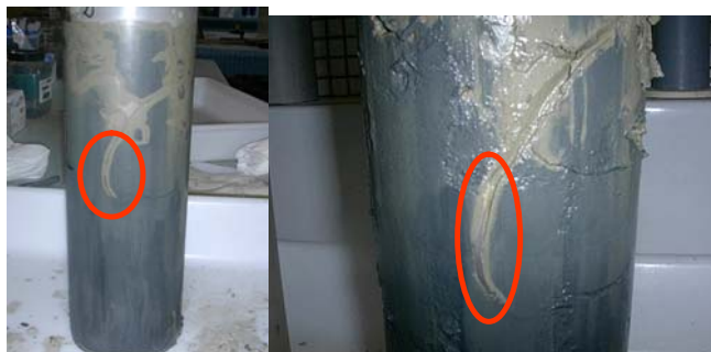
Figure 3 : Sédiment oxygéné autour du terrier d'une annélide sur la carotte sédimentaire prélevée à Esnandes.
