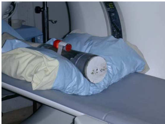
Figure 11 : Carotte en place sur le support du scanner
