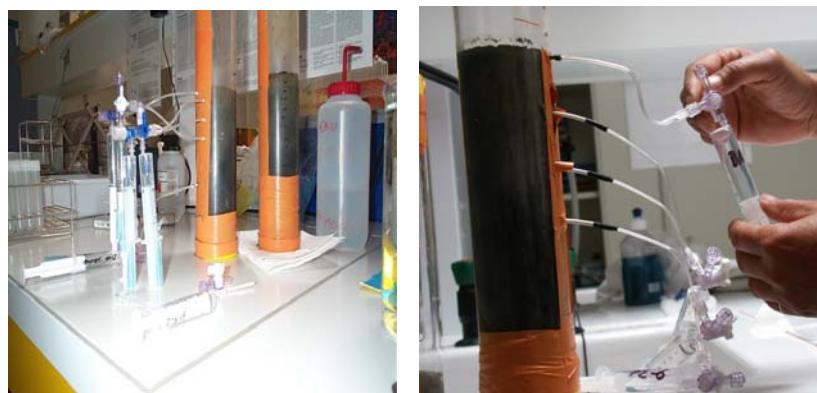
Figure 8 : Extraction de l'eau interstitielle à l'aide de rhizons
