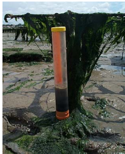
Figure 7 : Carottier utilisée pour le prélèvement du sédiment pour le dosage de l'azote ammoniacal ( \text{NH}_4^+ et \text{NH}_3 ) et des sulfures ( \text{H}_2\text{S} ) dans l'eau interstitielle
