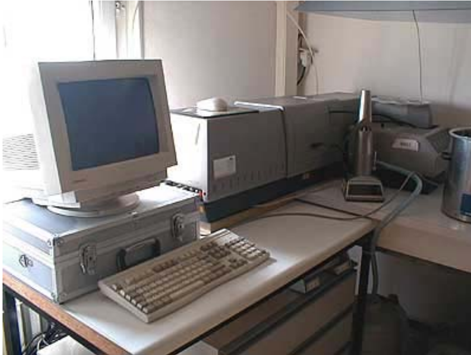
Figure 10 : Granulomètre laser Malvern de type Mastersizer
