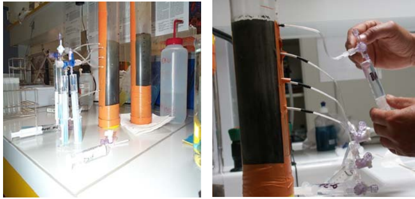
Figure 15 : Extraction de l'eau interstitielle à l'aide de rhizons
