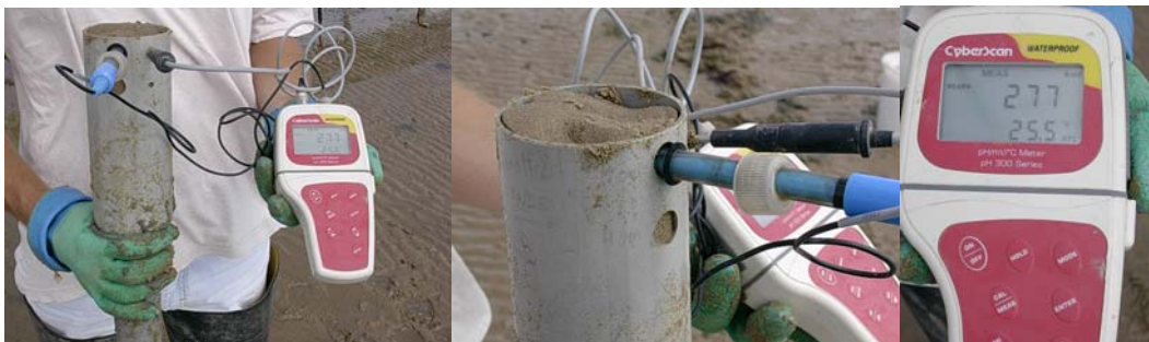
Figure 13 : Mesure in situ de la température, du pH et du Eh dans le sédiment
