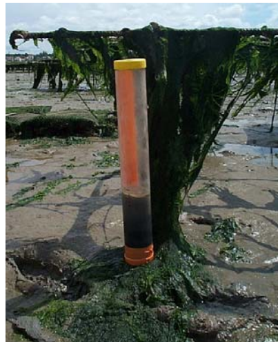
Figure 14 : Carottier utilisée pour le prélèvement du sédiment pour le dosage de l'azote ammoniacal ( \text{NH}_4^+ et \text{NH}_3 ) et des sulfures ( \text{H}_2\text{S} ) dans l'eau interstitielle
