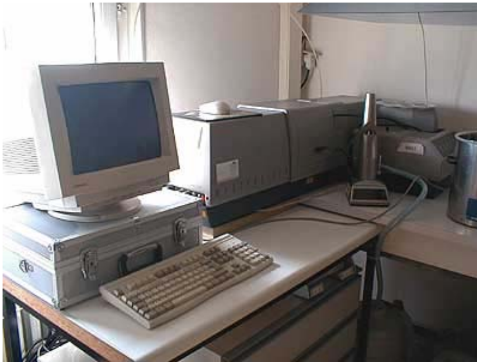
Figure 17 : Granulomètre laser Malvern de type Mastersizer
