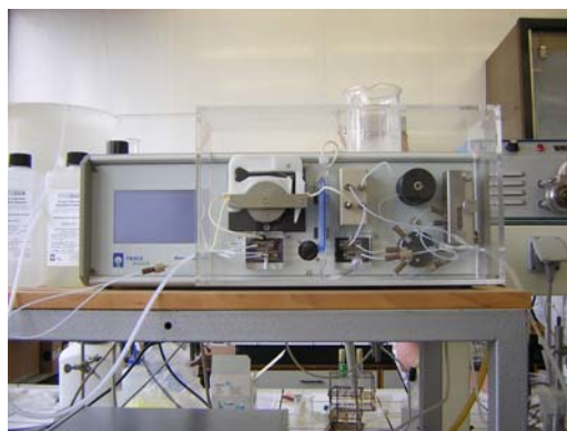
Figure A4.4. Analyseur 'ProcessTRACE' permettant la mesure en ligne de la concentration du glucose dans le milieu en g/L.
