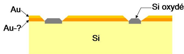
Figure 2.10 – Schéma d’après une analyse XPS d’une couche d’or de 2 nm avec une longue exposition à l’air.
