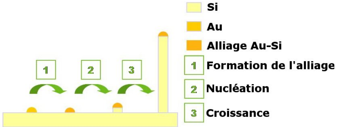
Figure 1.22 – Schéma de croissance de nanofils de silicium par mécanisme VLS [57].
