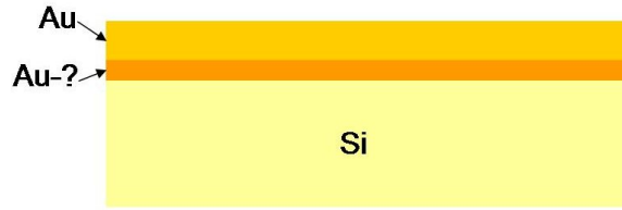
Figure 2.6 – Schéma d'après une analyse XPS d'une couche d'or de 2 nm avec une attaque HF sur le substrat.
