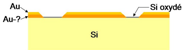
Figure 2.8 – Schéma d'après une analyse XPS d'une couche d'or de 2 nm avec une attaque HF sur le substrat.
