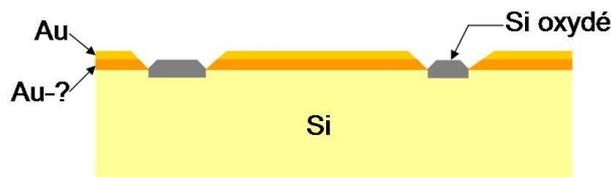
Figure 2.10 – Schéma d’après une analyse XPS d’une couche d’or de 2 nm avec une longue exposition à l’air.
