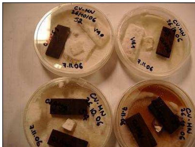
*Figure III-68 : Culture de Coriolus versicolor sur des échantillons de hêtre imprégnés PP CP lessivés, en comparaison aux témoins*
