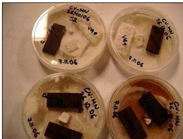
Figure III-68 : Culture de Coriolus versicolor sur des échantillons de hêtre imprégnés PP CP lessivés, en comparaison aux témoins
