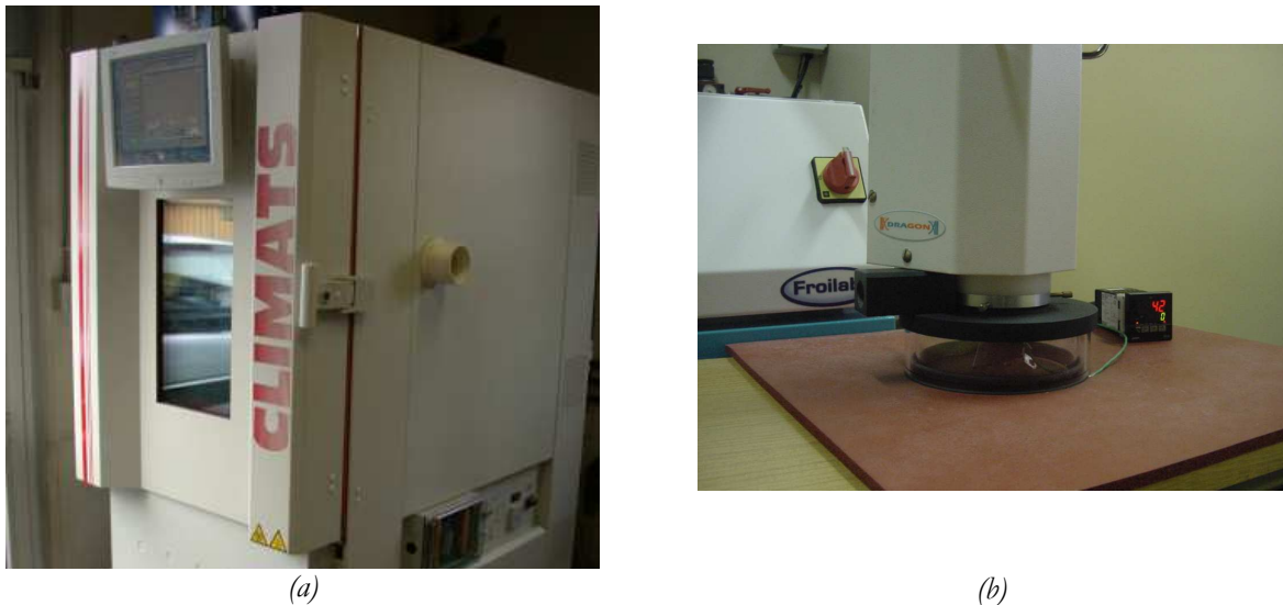
Fig.III.2 : (a) Enceinte climatique SAPRATIN Excal (LTN-INRETS), (b) Générateur d'air Dragon (SATIE)
