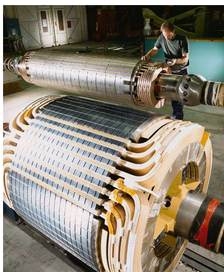
Rotors bobinés d'un alternateur 4 pôles (en premier plan) et d'un turboalternateur 2 pôles (en arrière plan)
