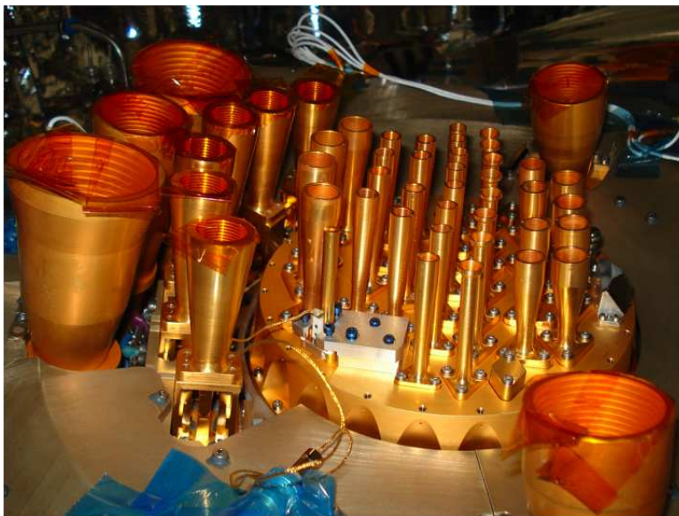
FIG. 2.2: Plan focal de Planck. L'instrument haute fréquence est au centre du plan focal.
