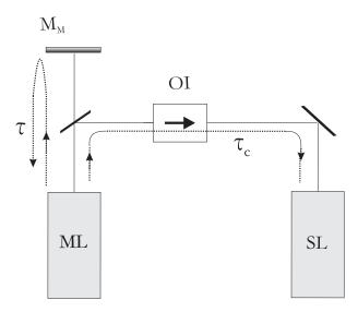
Figure B.7.1: Schéma type de couplage unidirectionnel pour la réalisation de la synchronization par injection optique isotrope. ML: laser maître; SL: laser esclave;  $M_M$ : miroir de la cavité externe de ML; OI: isolateur optique;  $\tau$ : delai de feedback optique;  $\tau_c$ : temps de parcours entre les lasers maître et esclave. Il s'agit du schéma dit à boucle ouverte car seul le laser maître comporte une cavité externe de feedback pour la génération du chaos optique.
