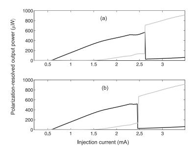
**Figure B.2.1**: Evolution des courbes de puissance de sortie dans les modes basse fréquence BF (x en noir) et haute fréquence HF (y en gris) du VCSEL<sub>1</sub>, pour un courant d'injection croissant (a1) et décroissant (b1). La température du VCSEL est stabilisée à 20° C.
