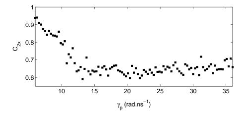
**Figure B.7.3**: Evolution de qualité de la synchronisation anticipative [mesurée via le coefficient de correlation  $C_{2x}$  défini à la page 159, eq. (8.2.12)] lorsqu'on varie la birefringence  $\gamma_p$  du VCSEL. La dégradation de la qualité de la synchronisation coincide avec le passage du système d'un régime chaotique dans les deux modes de polarisations orthogonales vers un regime chaotique dans un seul mode.
