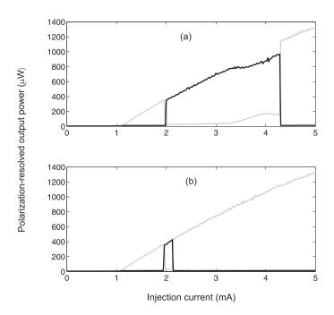
Figure B.2.2: Evolution des courbes de puissance de sortie dans les modes basse fréquence BF (x en noir) et haute fréquence HF (y en gris) du VCSEL<sub>2</sub>, pour un courant d'injection croissant (a1) et décroissant (b1). La température du VCSEL est stabilisée à 20° C.
