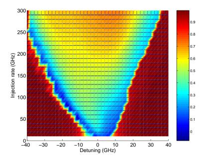
Figure B.7.6: Cartographie du coefficient de correlation isochrone  $C_{x_M,y_S}$  entre l'intensité du mode x de SL et celle du mode y de SL dans les plan des paramètres d'injection (detuning, taux d'injection). Les paramètres internes du modèle sont les mêmes que ceux indiqués à la Figure B.7.5.
