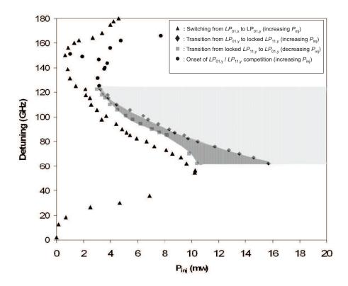
Figure B.6.1: Cartographie expérimentale du basculement de polarisation et de la compétition des modes transverses du  $VCSEL_2$  dans le plan des paramètres d'injection optique (Detuning= $\Delta \nu = \nu_{ML} - \nu_{SL}$  et puissance injectée  $P_{inj}$ ). Le courant d'injection est fixé à 2.105 mA et la température est maintenue à  $20^{\circ}C$ .
