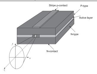
Figure B.1.1: Schéma d'un laser conventionnel émettant par le côté. La direction d'emission (z) est parallèle au plan de la zone active (active layer) placée entre deux enveloppes respectivement dopés N et P.
