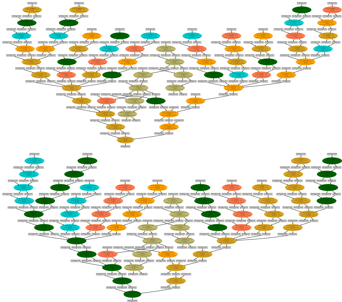
FIG. 10.9 – Différence sur le placement des tâches entre ETF (haut) et DSC (bas) sur 5 processeurs (A visionner en couleur pour une meilleure appréciation). Alors que DSC regroupe les séquences dominantes de tâches, ETF choisit la premier processeur libre qui permet d'exécuter une tâche au plus tôt.
