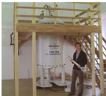
Figure 6.2 Spectromètre haute résolution d'un champ magnétique de 17,6 T (Avance 750 Wide Bore - Bruker Biospin, Wissembourg, France) du CEMHTI (CNRS UPR3079 - Campus CNRS d'Orléans)
