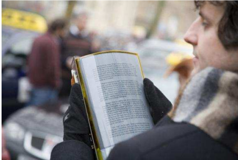
FIGURE 1.5 – En utilisant des supports d’affichage flexibles, l’e-paper promet une ergonomie inédite pour la lecture numérique (ici, un prototype de Plastic Logic)
