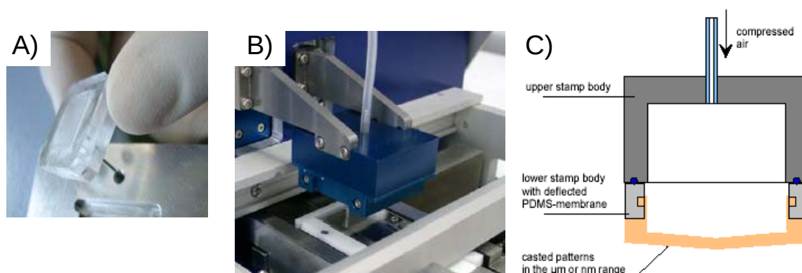
Figure 40 : A) image du timbre utilisé pour le tamponnage moléculaire, B) automate (GESIM) de dépôt par micro contact printing, C) schéma du principe du tamponnage par une membrane soumise à une pression (0.2 bar)
