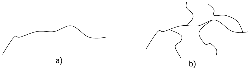
Figure I.10. : Structure a) du HDPE, b) du LDPE.
