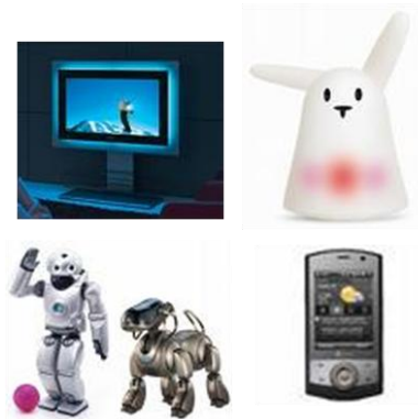
Figure 2. Exemple d'objets communicants Une télévision « ambilight » de Philips, Un Nabaztag, Les robots-jouets de Sony et un Smartphone
