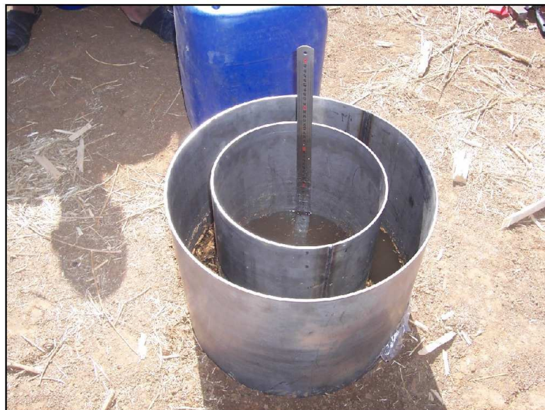
Photo 27 : Appareil à double anneau permettant les mesures d'infiltration
