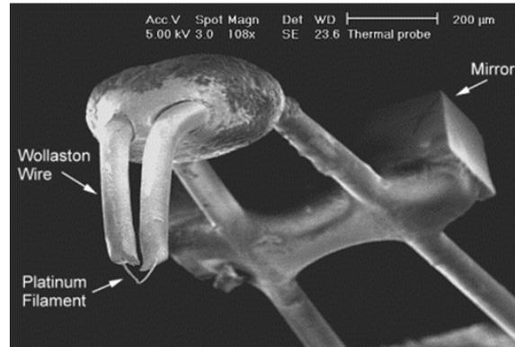
Figure II-5 : Image MEB d'une sonde de Wollaston [22]
