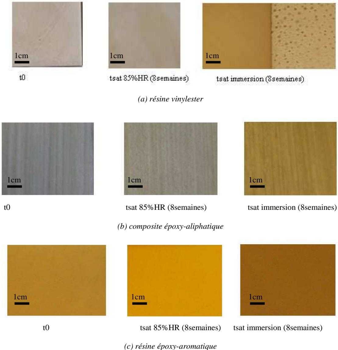
Figure A-27 : Photos des plaques de résine et composite avant et après vieillissement
