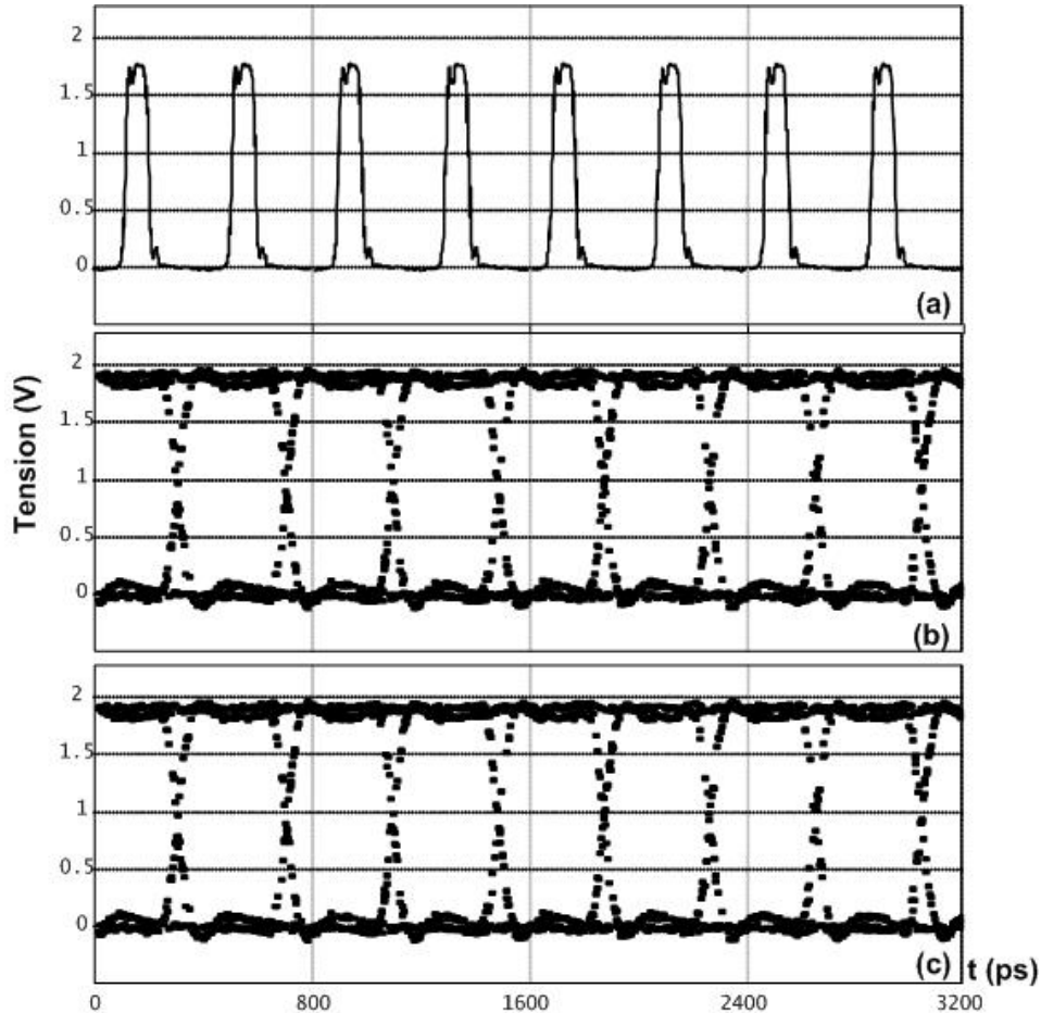
Figure.II.19 : Traces temporelles des signaux de commande a) Signal de commande du MZM_75630 généré par le ParBERT. b), c) Signaux de données (PRBS) des utilisateurs à 2.5 Gb/s, générés par le ParBERT
