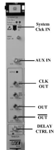
Figure.II.5 : Module de génération de données à 13.5 Gb/s N4872A.
