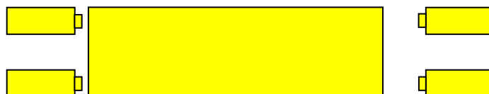
Figure 1-16 : dispositif de type RAIMI avec zone de contact plus étroite (bobine non représentée) (RAIMI-like magnetic system with smaller contact areas)
