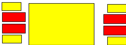
Figure 1-14 : dispositif magnétique de type RAIMI avec contacts en matériau amagnétique (rouge) décorrésés des aimants fixes (jaunes) (bobine non représentée) (RAIMI-like magnetic system with non magnetic contacts)
