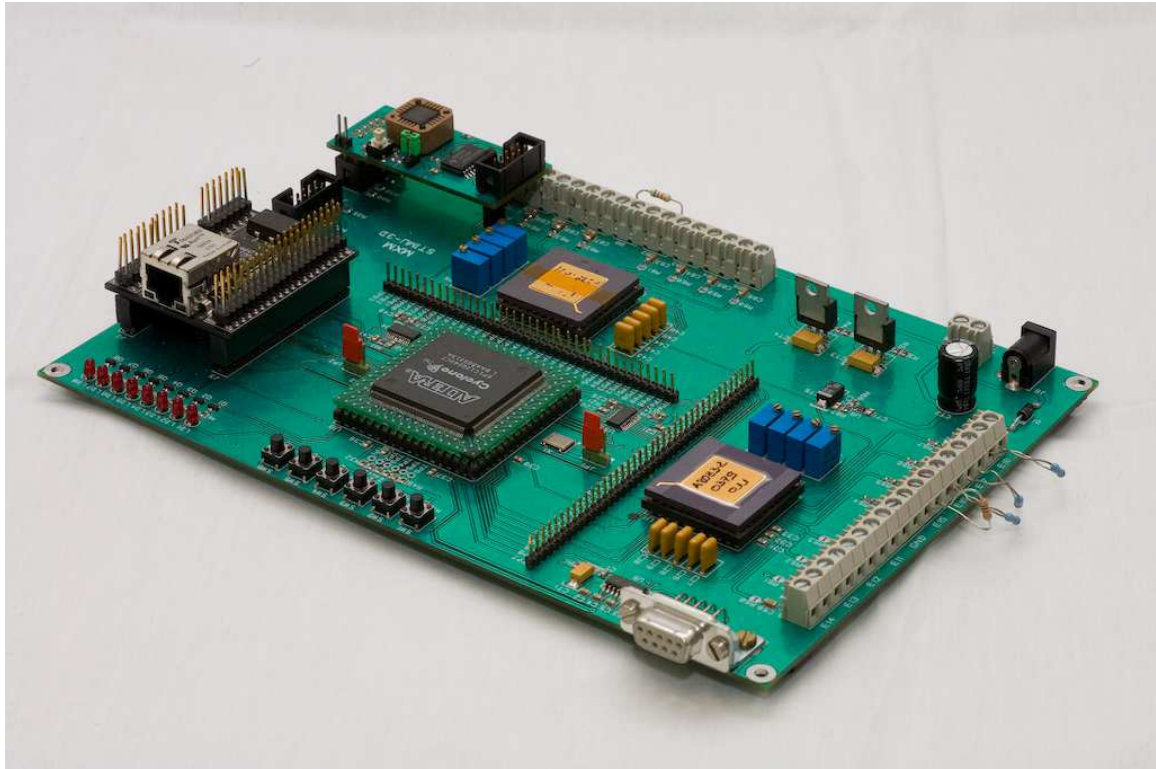
FIG. 4.18 – Prototype en électronique discrète composée d’un FPGA (Cyclone Altera) pour la parie numérique et 2 ASIC#1 SENIS. Ce prototype est utilisé pour les essais sur animaux, les tests des protocoles d’identification des conductivités intracrâniennes avec ODYSSEE, et en per-opérateur.
