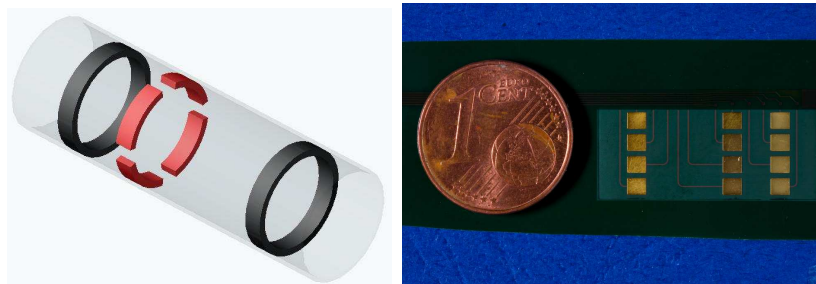
FIG. 4.14 – a) Vue CAO d’une électrode quadripolaire (4 cathodes couleur cuivre) comportant deux anodes asymétriques (en noir). b) Réalisation 12 pôles à plat où les deux anodes sont elles mêmes découpées en 4 contacts.
