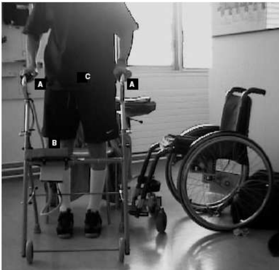
FIG. 4.6 – Ensemble du système externe avec les 4 boutons poussoirs (A), le séquenceur (B) et l'antenne (C).
