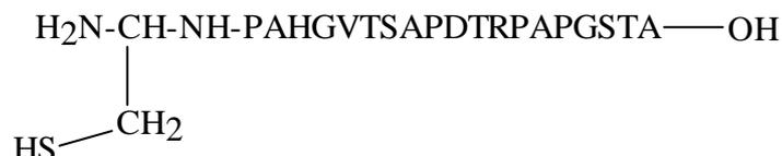
Fmoc-Ala-Wang-PS (250 mg de résine sèche ; substitution : 0,4 mmoles/g) est traitée par une solution de pipéridine à 20% dans du CH<sub>2</sub>Cl<sub>2</sub> (5 ml), 3 x 5 min. La synthèse sur phase solide a été ensuite réalisée en stratégie Fmoc/*t*Bu selon la procédure générale. Le rendement de couplage de 96% est évalué par le dosage du Fmoc libéré du dernier acide aminé de la séquence (430 mg de résine sèche, 0,096 mmol).
