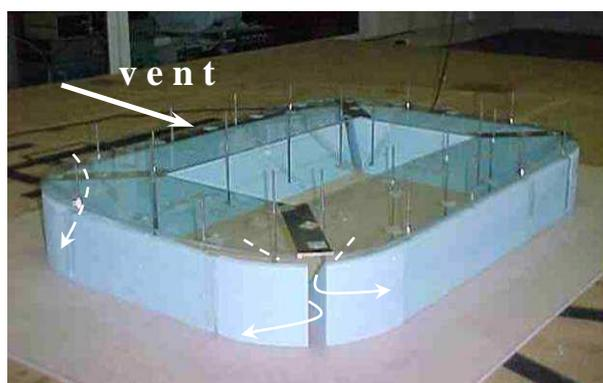
*Description* : Cette configuration possède des brèches verticales de largeur de 7.5 mètres, aux niveaux des angles du stade. La toiture couvre l'intégralité des gradins.
