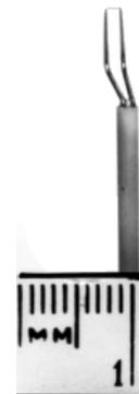
Figure 75 : Anémomètre à fil chaud
