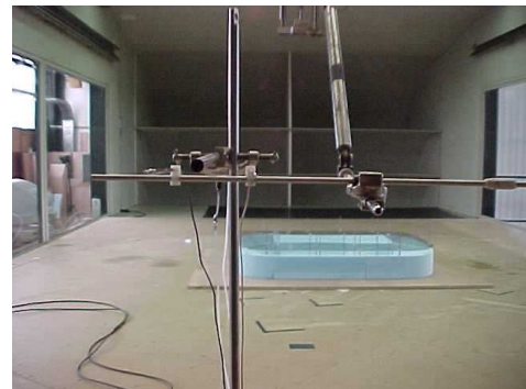
Figure 76 : Sonde placée à côté de la référence, du tube de Pitot
