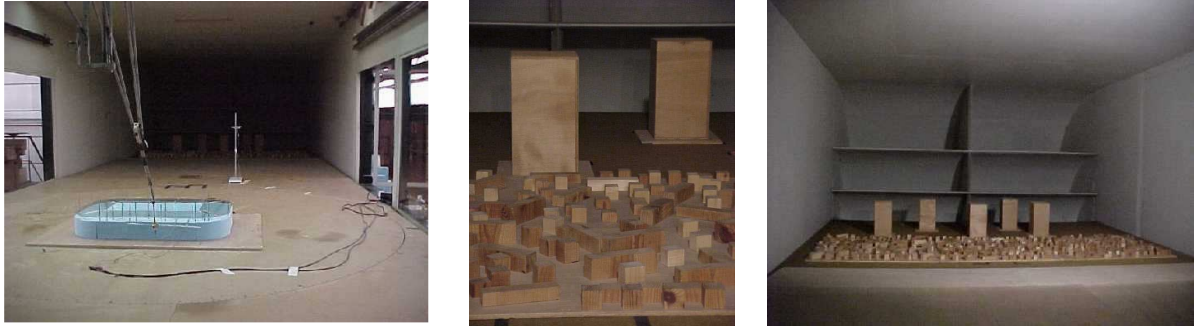
Figure 72 : Maquette dans la veine I — Détail de rugosité — Ensemble des éléments de rugosité
