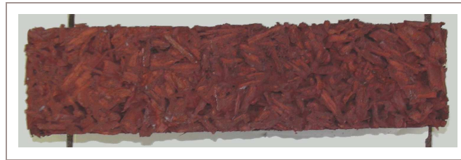
Figure A14.1 : Béton de bois sans efflorescence
