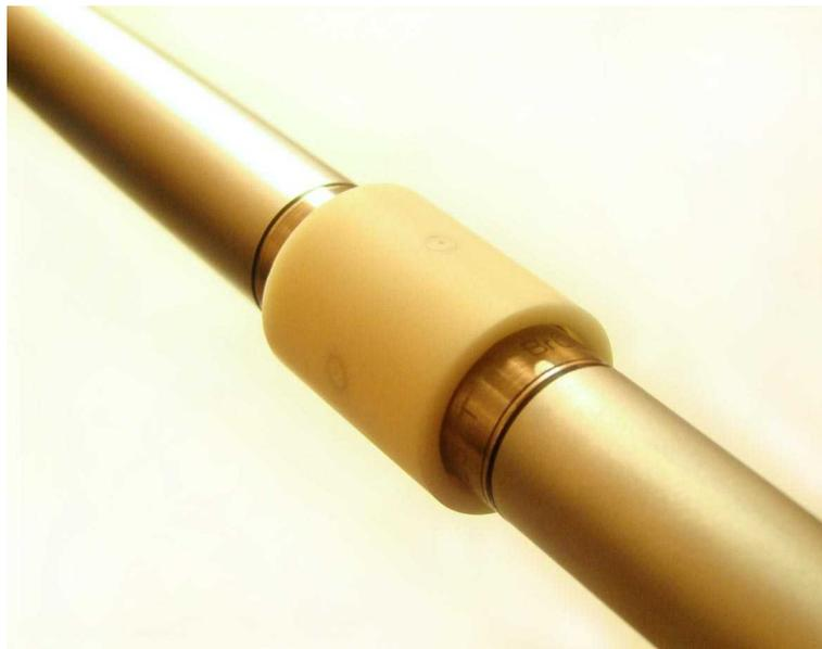
Figure C.1. Coupleur de haute précision pourvu d'un réseau de quatre tubes ouverts.
