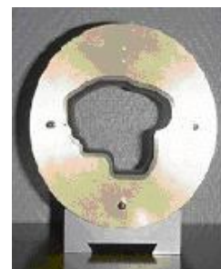
Figure 3 : le collimateur, il conforme la dose au profil tumoral.
