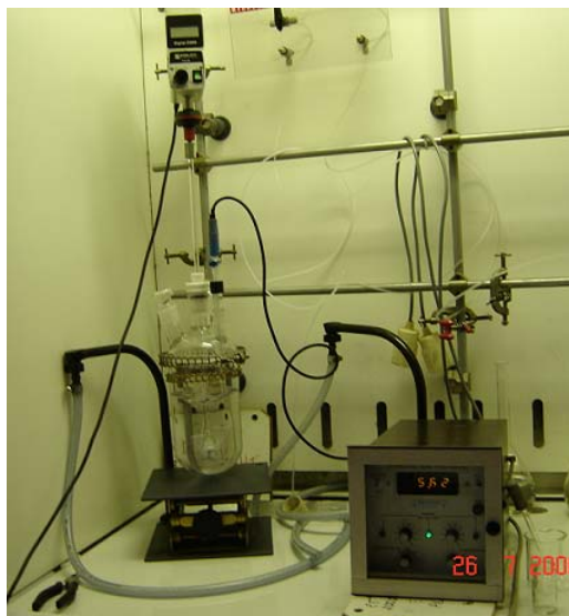
Image II.1 : Réacteur de préparation des catalyseurs
