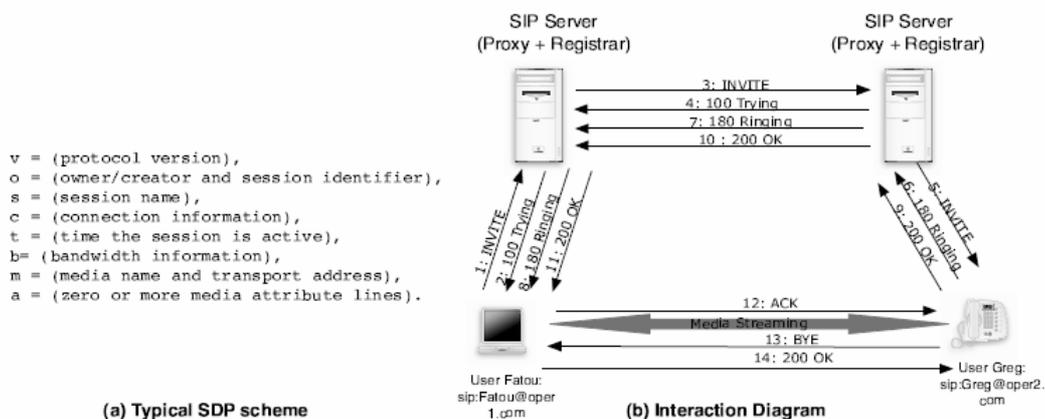
**Figure 23 Principes et architecture d'une session SIP**
