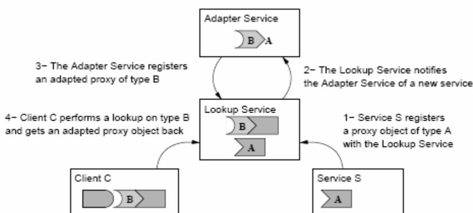
Figure 14 Service d'adaptation et répertoire d'Adapteurs [Vay01]
