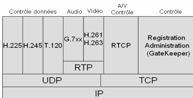
**Figure 28 Agencement des protocoles utilisés par le protocole H.323**
