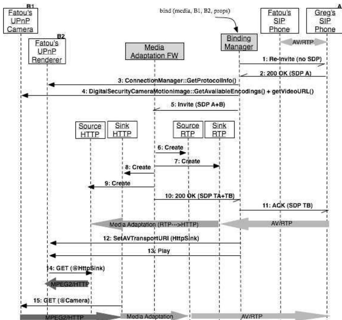
**Figure 82 Interactions entre équipements SIP, UPnP et transcodeur**
