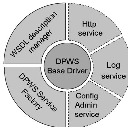
**Figure 72 Vision schématique du DPWS Base Driver**
