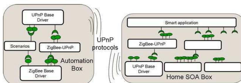
**Figure 53 Pont protocolaire entre deux plateformes intelligentes**
