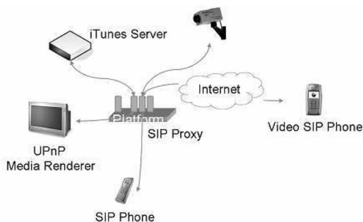
**Figure 10 Terminal de télécommunication éclaté sur plusieurs équipements**
