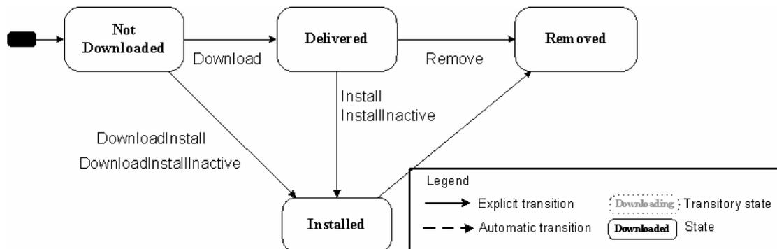
**Figure 38 Diagramme d'état du Delivery Package SCOMO**
