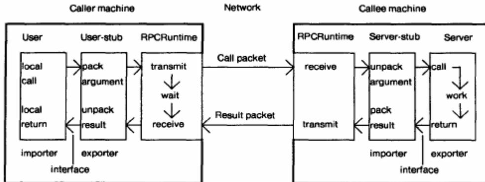
Figure 7 Système d'appel de procédure distant [BiN84]
