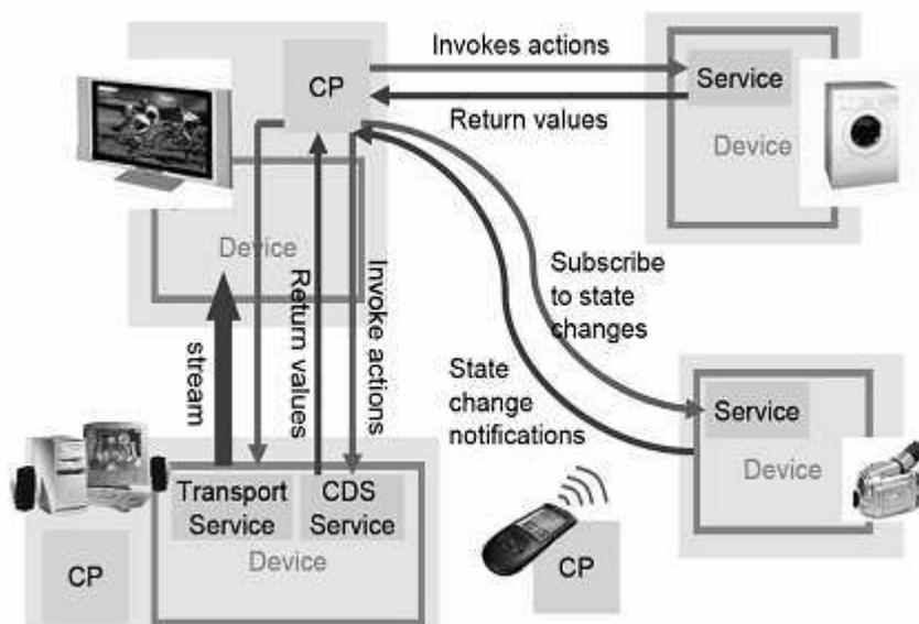
**Figure 19 Points de contrôle, équipements et services UPnP**
