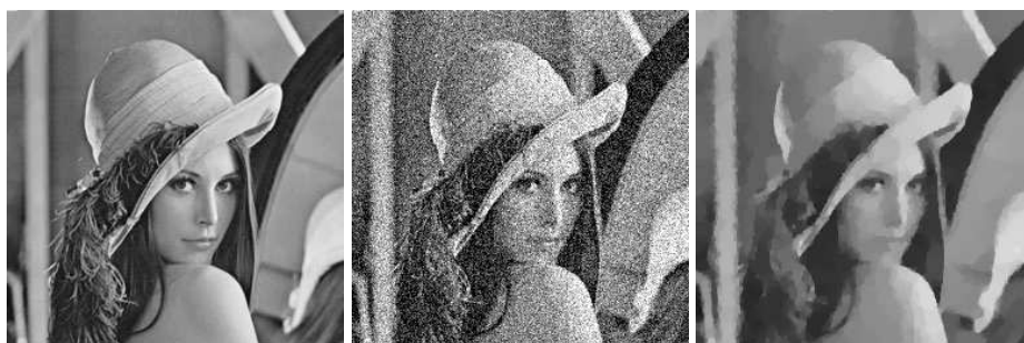
FIG. 5.2 – De gauche à droite : image originale (valeur dans [0, 1] ) - image bruitée (bruit gaussien) - restauration par variation totale avec p = 2 et \alpha = |b|_{L^2(Y)} .
