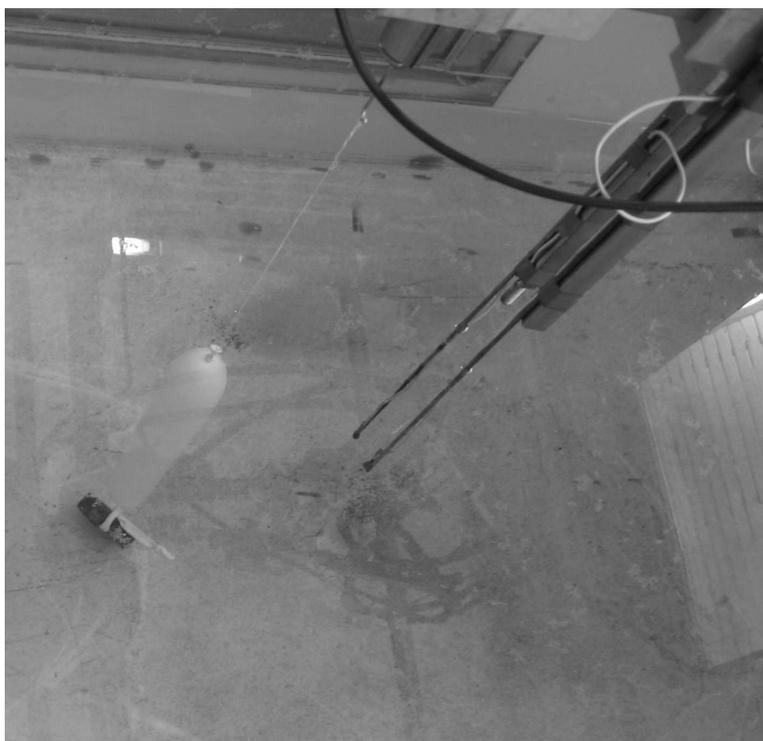
FIG. 4.2 – Photo de l'expérience pour l'acquisition de données de champs diffractés par un fantôme en eau savonnée (contenu dans un préservatif) d'os long immergé dans l'eau.
