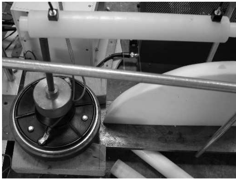
FIG. 11.2 – Photographie du montage expérimental pour mesurer la réponse vibratoire d'un fantôme d'os long contenant un canal médullaire dont on peut varier la contenance fluide. L'objectif des expériences avec ce type de montage est d'évaluer l'influence de la nature et de la viscosité du fluide médullaire sur les modes (notamment, leurs fréquences propres) de vibration du spécimen. Ici l'os est excité acoustiquement via une chambre de compression (tube vertical en bas et à gauche) ; ce type de sollicitation favorise l'excitation des modes de flexion du tube. La réponse est mesurée au moyen de deux accéléromètres (cubes noirs au contact de l'os).
