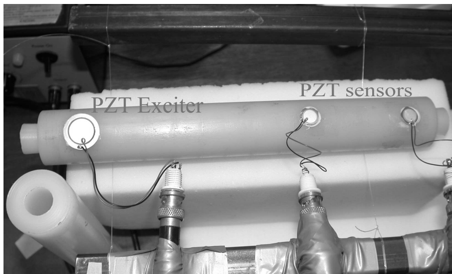
FIG. 11.4 – Montage expérimental avec des transducteurs PZT pour mesurer la réponse vibratoire d'un fantôme d'os long contenant un canal médullaire dont on peut varier le contenu fluide.
