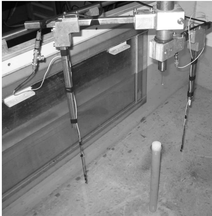
FIG. 4.1 – Photo de l'expérience pour l'acquisition de données de champs diffractés par un fantôme en nylon d'os long immergé dans l'eau.
