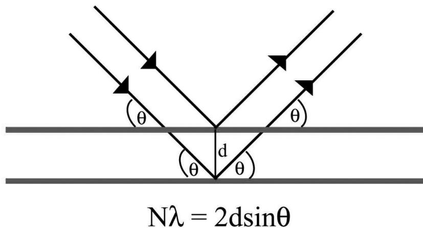
*Figure 16: Représentation schématique de la diffraction selon la loi de Bragg.  $N$  : nombre entier,  $d$  : distance entre les plans qui diffractent,  $\theta$  : angle d'incidence du faisceau de rayon X*
