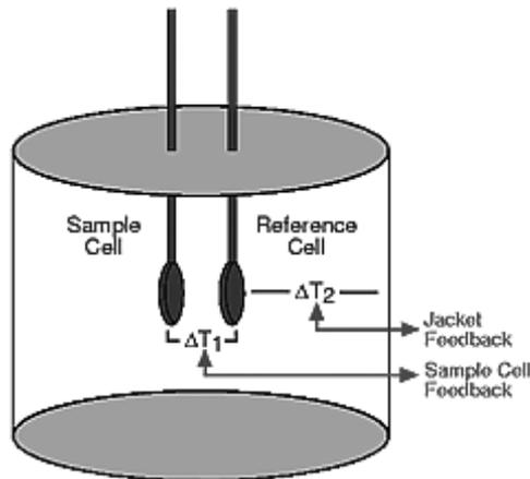
Figure 15: Représentation schématique d'un microcalorimètre.
