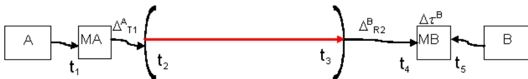
FIG. 1.4 : Schéma du transfert de temps à une voie.
