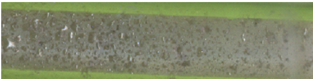
Figure I.3.7 – Photographie d'un cristal de \text{Tl}_3\text{PbCl}_5 présentant des bulles sur sa périphérie.
