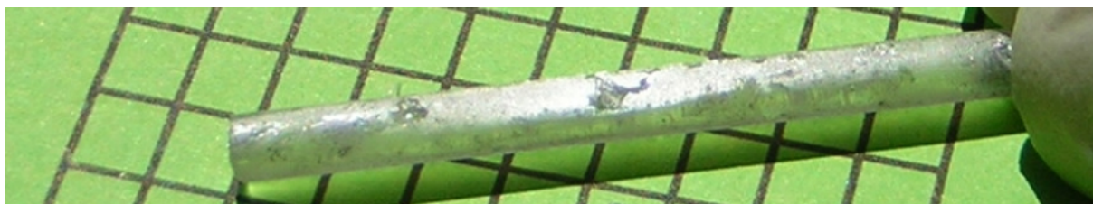
Figure I.3.6 – Photo d'un cristal de Tl_3PbBr_5 pur brut de croissance (graduation 5mm). Il est possible de distinguer la facette sur la face supérieure du cristal.
