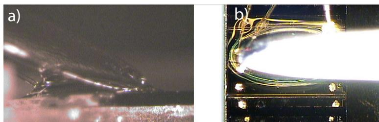
**FIG. 6.6** – a) Goutte stable d'IPA vue avec la caméra 1. b) Goutte stable d'IPA vue avec la caméra 2.
