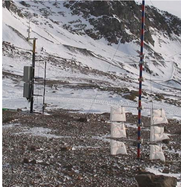
Figure 3.4 : Filets de références pour le calibrage de FlowCapt pendant l'hiver 2004-2005.
