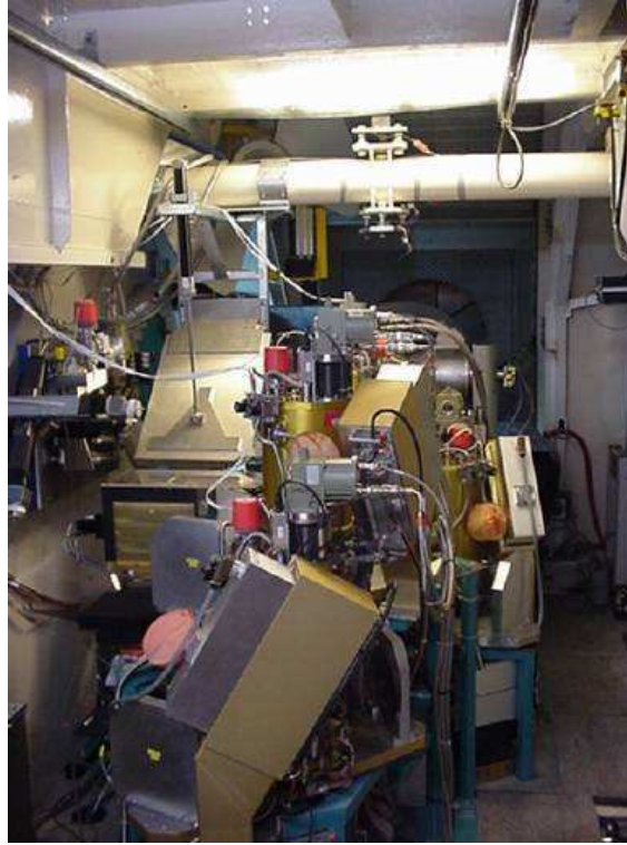
FIG. 2.2: Photographie de la cabine des récepteurs de l'antenne de l'IRAM. Les récepteurs sont refroidis par un cryostat, qui fonctionne à l'hélium liquide, de manière à baisser le niveau du bruit électronique des appareils. (Photographie réalisée lors des observations de Mars, en octobre-novembre 2005).
