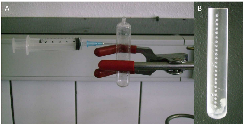
Figure II-12 : A. prélèvement des fractions le long du gradient d'ultracentrifugation, B. guide pour le prélèvement des 23 fractions le long du gradient d'ultracentrifugation
