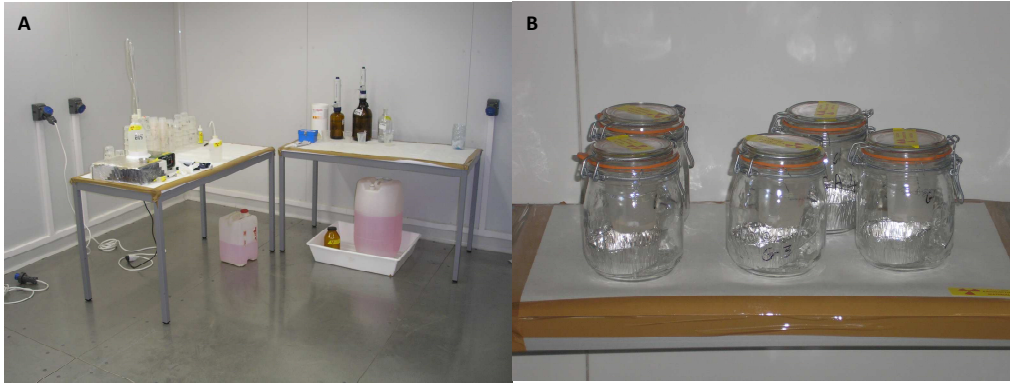
Figure II-3: A. Dispositif expérimental pour le suivi de la minéralisation de l'atrazine et de la respiration, B. Bocaux de verre dans lesquels est incubé le sol avec les pièges à CO 2 .
