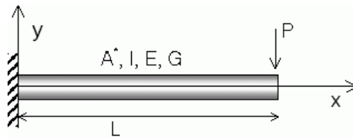
FIG. 2.19 – Poutre console sollicitée par une charge transversale.
