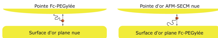
Figure 49 : Schéma représentant l'équivalence du champ « diffusif » entre l'approche d'une pointe Fc-PEGylée vers une surface d'or nue, et l'approche d'une pointe AFM-SECM nue vers une surface Fc-PEGylée.
