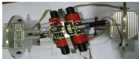
FIG. 2.2 – Deux modules parallèles (Vertèbres) connectés en série
