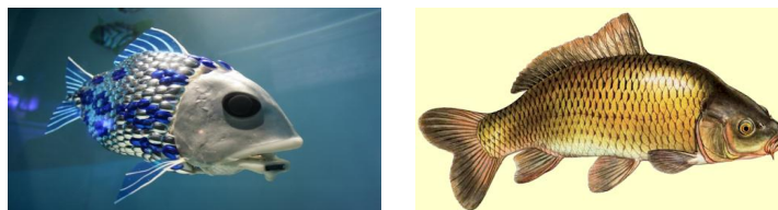
FIG. 1.7 – Le robot G9 de l'université d'Essex inspiré du poisson carpe " nfttu.blogspot.com ", " www.odile-halbert.com "
