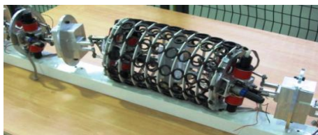
FIG. 2.7 – Armature proposée pour la peau
