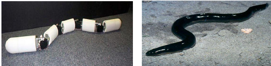
FIG. 1.10 – Le robot REEL II de l'université de Harvard inspiré de l'anguille " fin-ckypenguin.wordpress.com "
