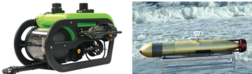
FIG. 1.3 – Le robot téléopéré LBV600 de la société Seabotix et le robot Autonome GAVIA de la société Hafmynd
