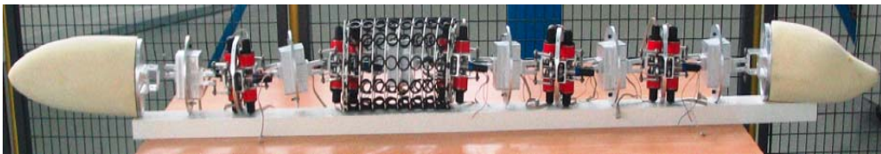
FIG. 2.1 – Le prototype du robot Anguille ne comportant que la partie mécanique des vertèbres
