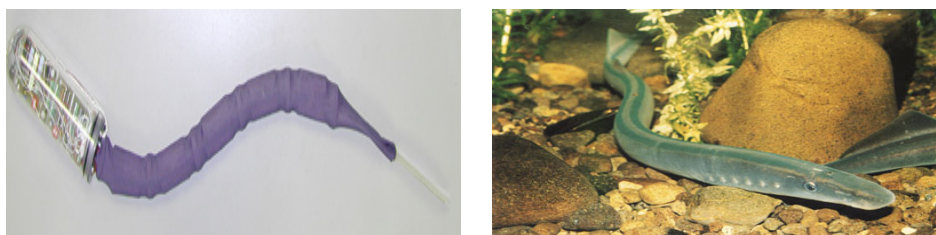
FIG. 1.11 – Le robot Lamprey de l'université de Northeastern inspiré du poisson Lamproie " www.doc.govt.nz "
