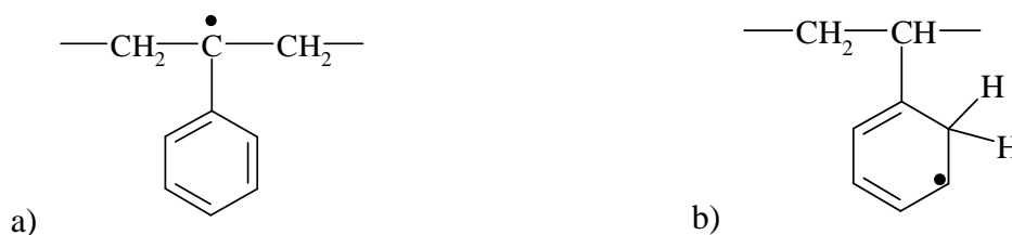
Figure I.3-5 : Radicaux formés lors de la radiolyse du polystyrène. a) radical benzyle, et b) radical cyclohexadienyle.
