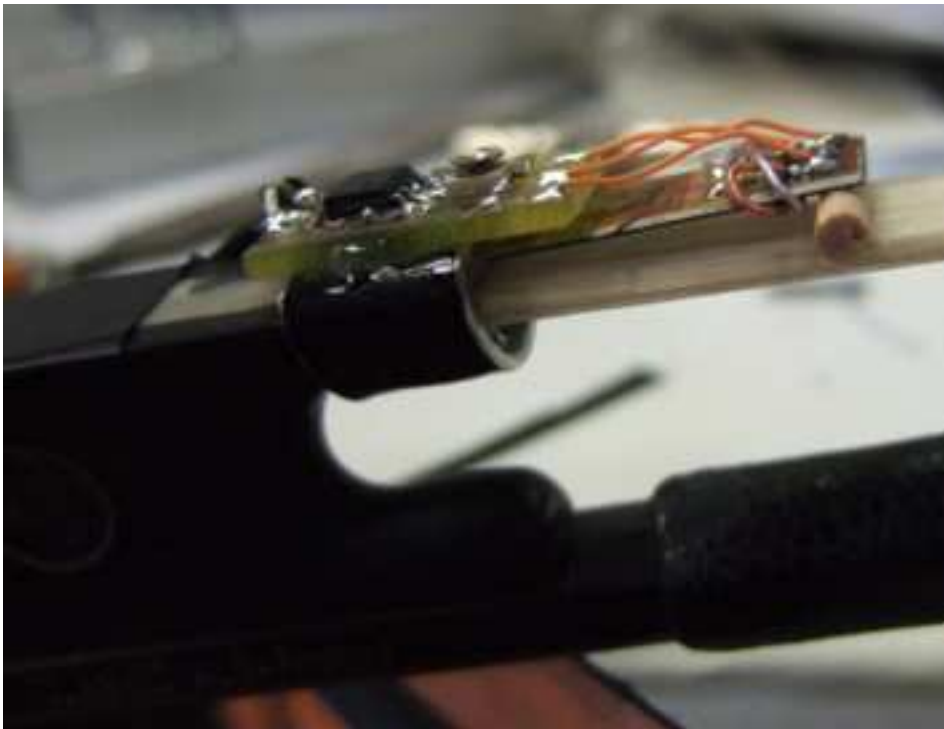
FIG. 2.4 – Capteur de pression : un jauge de contrainte est placée sur une plaque en appui sur la mèche de l'archet. Elle mesure les déflexions de la mèche à partir de laquelle il est possible de déduire la pression sur la corde. L'ensemble est fixé sur la bague de la hausse de l'archet.
