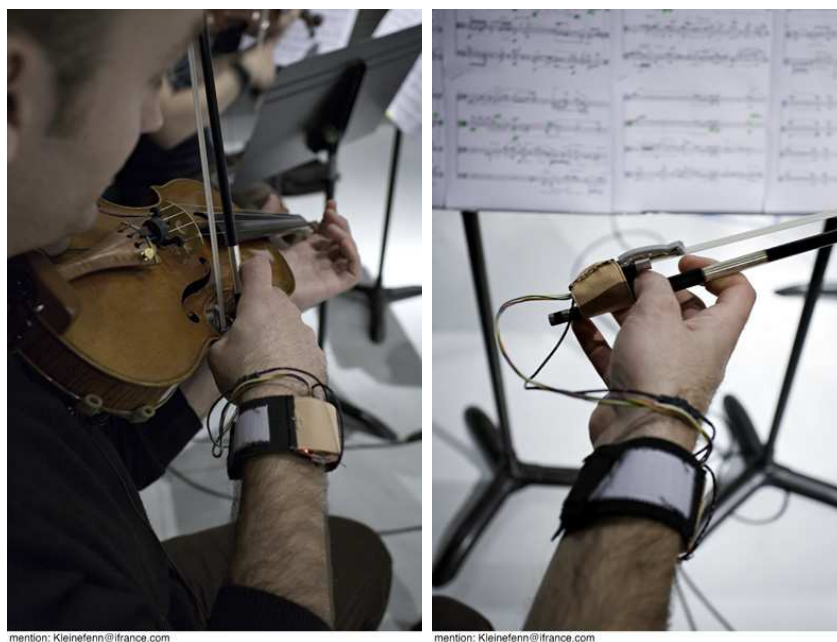
FIG. 2.3 – Dernière génération de module de captation de l'IRCAM. Seuls les accéléromètres sont placés sur l'archet et le reste de l'électronique, notamment l'émetteur sans fil et les batteries, est déporté sur le poignet. Egalement visible sur la photo de gauche placé sur la mèche de l'archet, un prototype de capteur de pression, recouvert de mousse protectrice.
